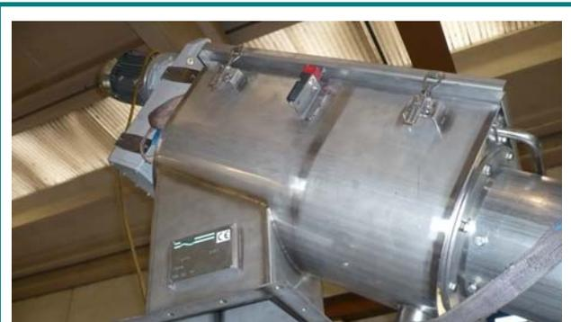
La motorizzazione è realizzata con un motoriduttore ad accoppiamento diretto la cui protezione, da sovraccarichi, può essere realizzata con limitatori di coppia elettromeccanici.
