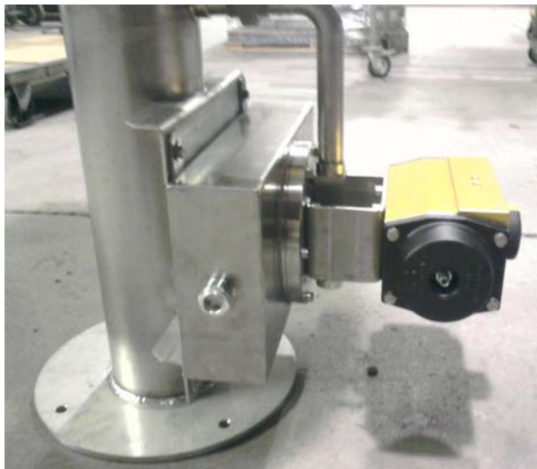
FILTRO A GRANIGLIA CON SCARICATORE DI CONDENSA A COMANDO PNEUMATICO (pressione massima 350 mbar)
